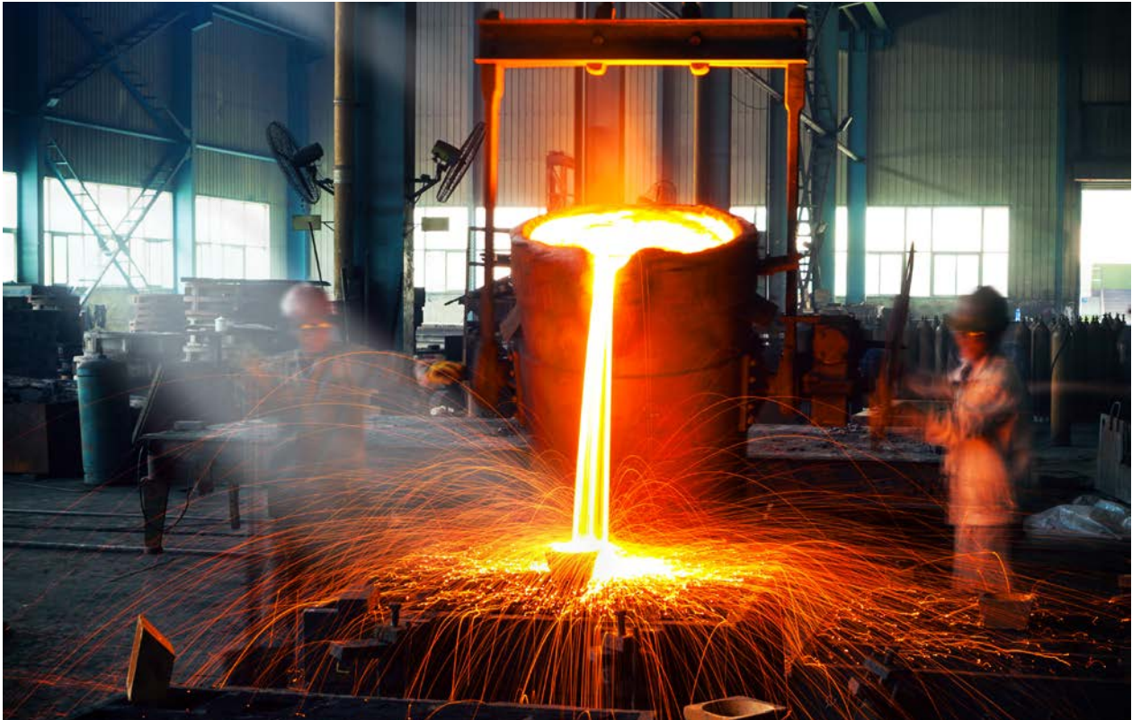
Abb. 1: Beim Sandgießen wird das Modell des Werkstücks mit einem Formstoff (z. B. Sand und Bindemittel) abgebildet, dann entfernt und der verbliebene Hohlraum mit dem geschmolzenen Werkstoff ausgegossen.
