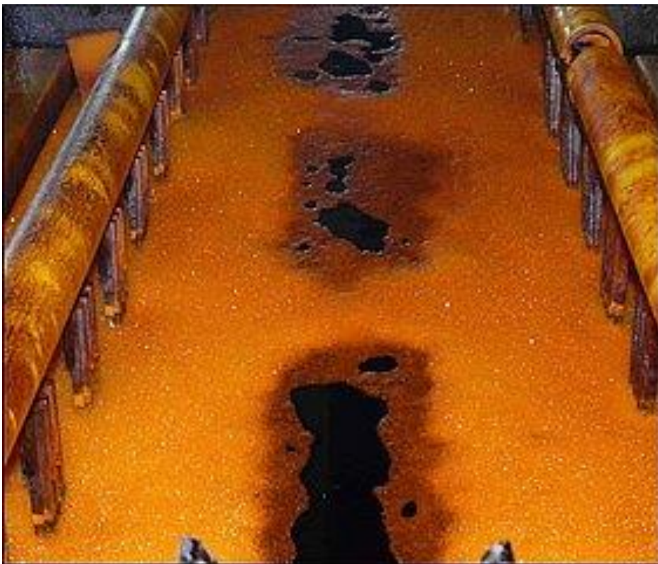
PFOS bildet an der Oberfläche von galvanischen Bädern einen Schaum, der Cr(VI)-haltige Aerosole unterdrückt © tzw
